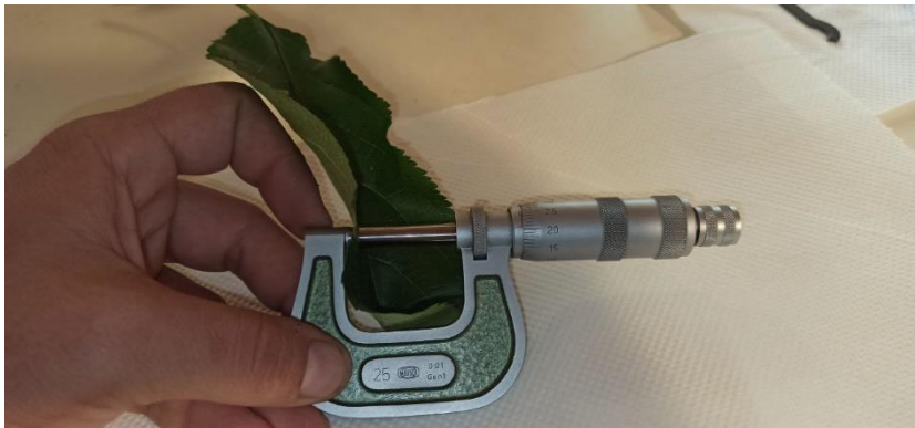
Figura 3: calibro utilizzato per la misurazione dello spessore totale della lamina fogliare;
